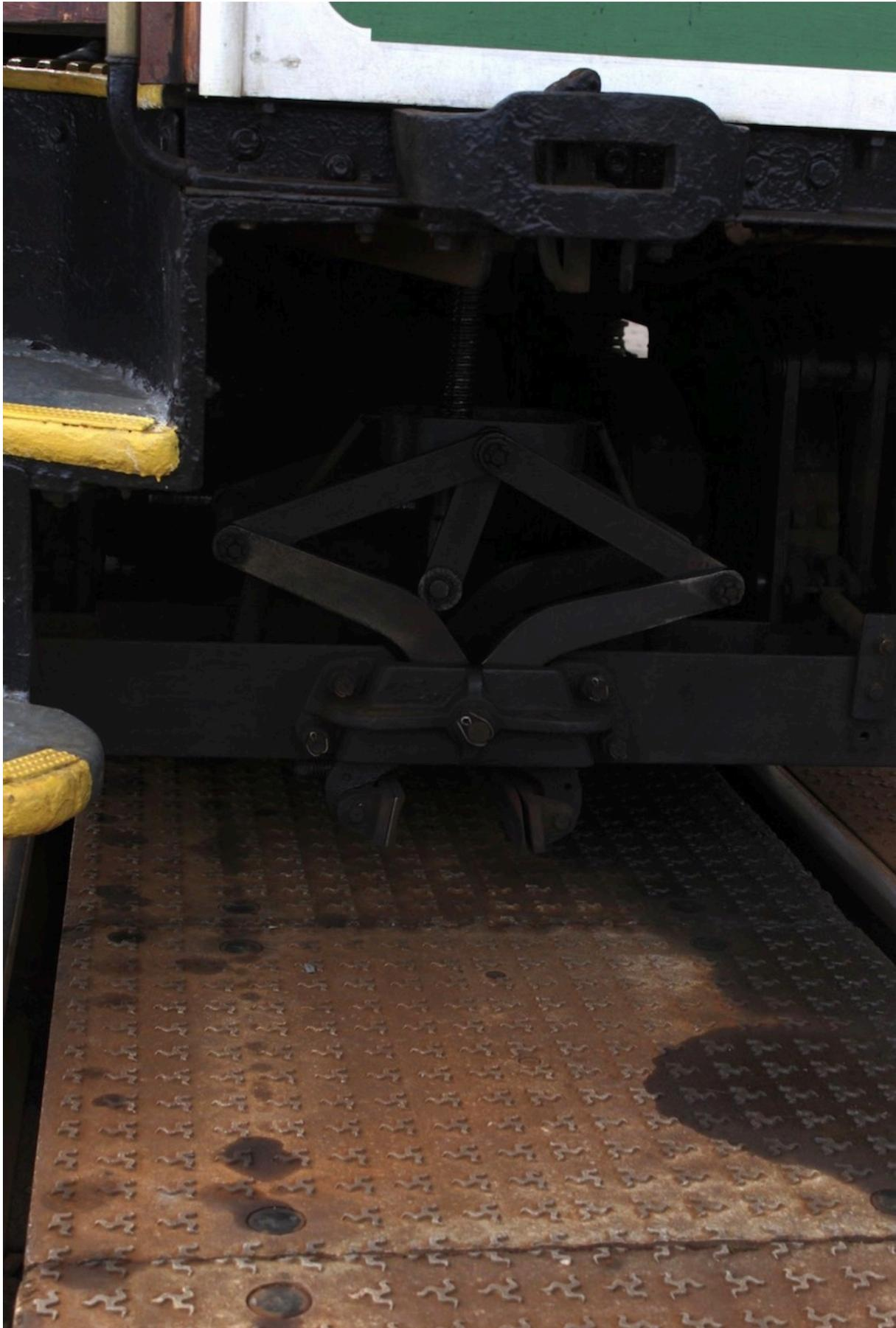
Des mâchoires commandées par un volant comme moyen de freinage.
