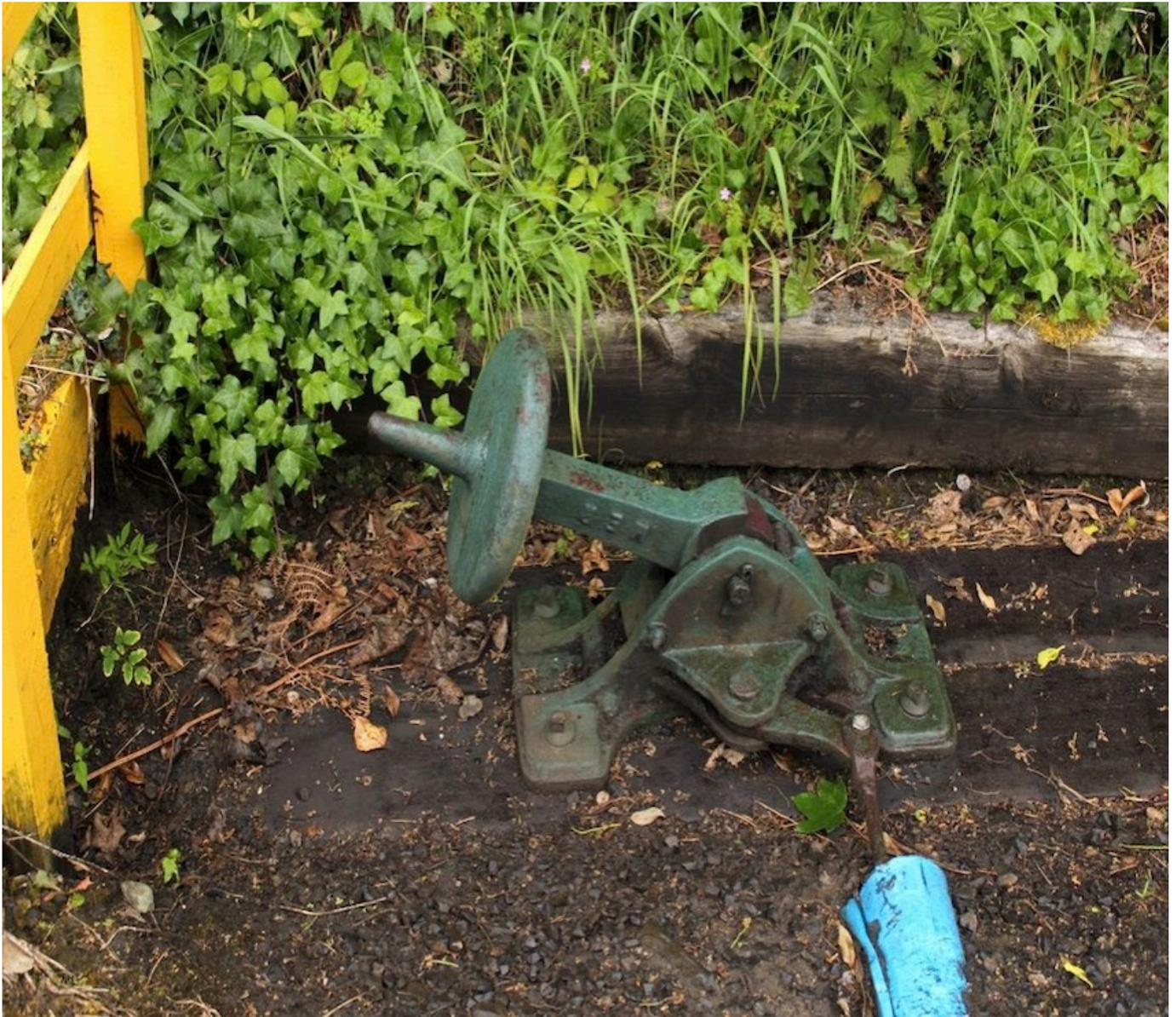
Levier d'aiguillage (Laxey dépôt SMR)
